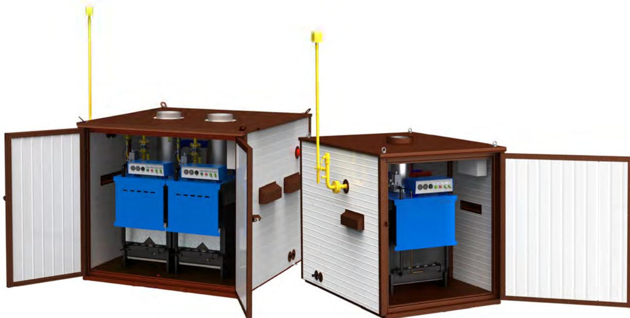
Котлы наружного размещения RS-H являются водогрейными водотрубными котлами в утепленном металлическом блоке. Для удобства обслуживания передняя и задние панели выполнены открывающимися. Теплообменник выполнен из оребренных труб с повышенной поверхностью теплоотдачи.
